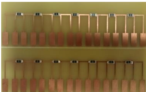
Obr. 38 - testované součástky a DPS, povrchová úprava - Cu
