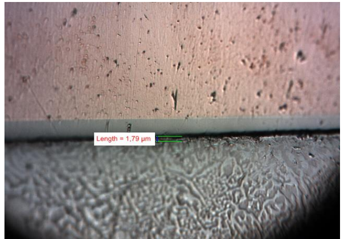
Obr. 23 - výbrus, Sn42Bi58, ENIG povrchová úprava – parametry nastavení pece: 110/130/155 °C
