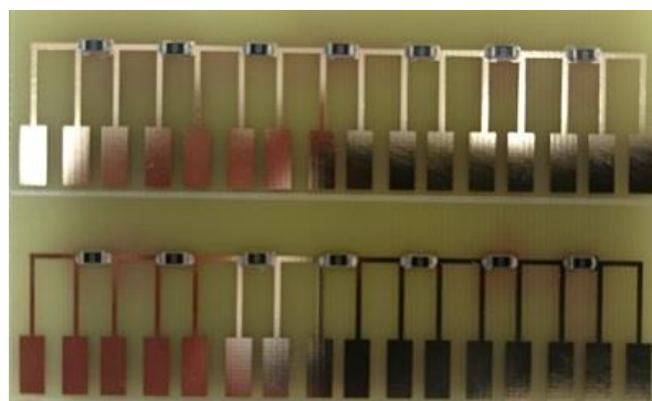
Obr. 40 - testované součástky a DPS, povrchová úprava –ENIG
