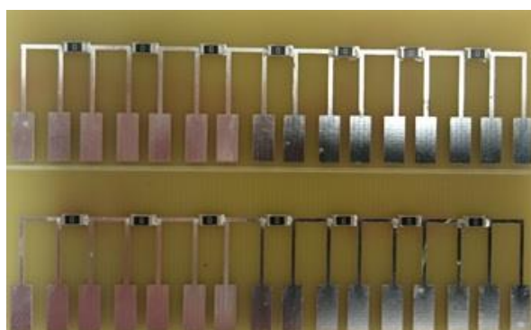
Obr. 39 - testované součástky a DPS, povrchová úprava –HAL
