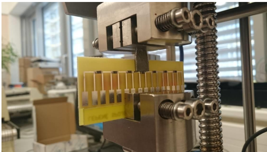
Obr. 36 – namáhání čelisti na součástku
