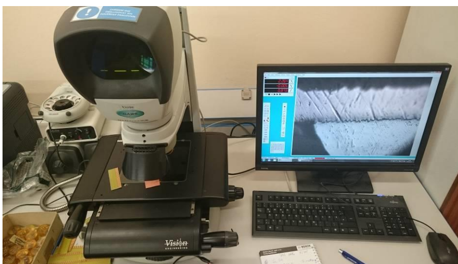
Obr. 41 - optická analýza výbrusu pod mikroskopem
